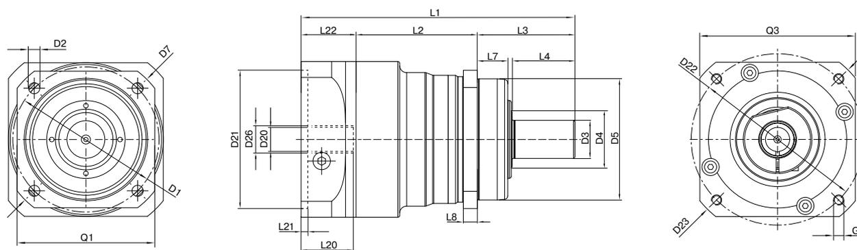
Darstellung entspricht einem PSN090 / 1-stufig / glatte Abtriebswelle / 14 mm Spannsystem / Motoranpassung – 2-teilig – runder Universalfansch / B5 Flanschtyp Motor
