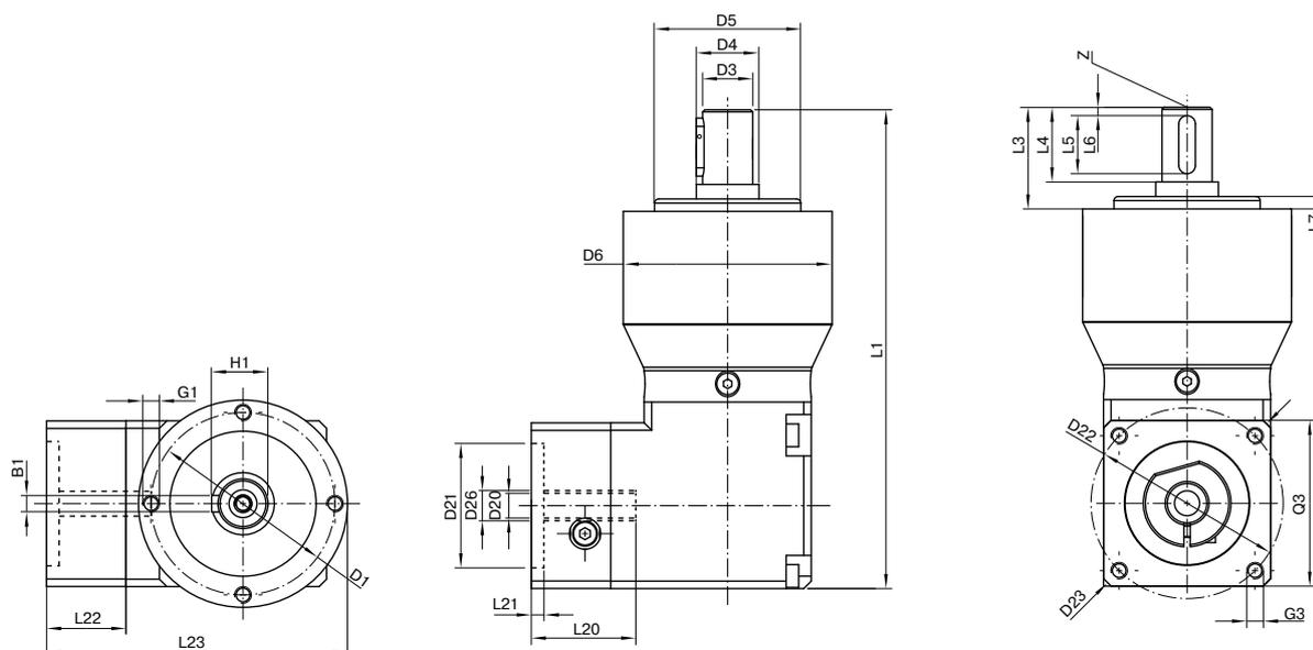
Darstellung entspricht einem WPLPE090 / 1-stufig / Abtriebswelle mit Passfeder / 19 mm Spannsystem / Motoranpassung – 2-teilig – quadratischer Universalfansch / B5 Flanschttyp Motor
