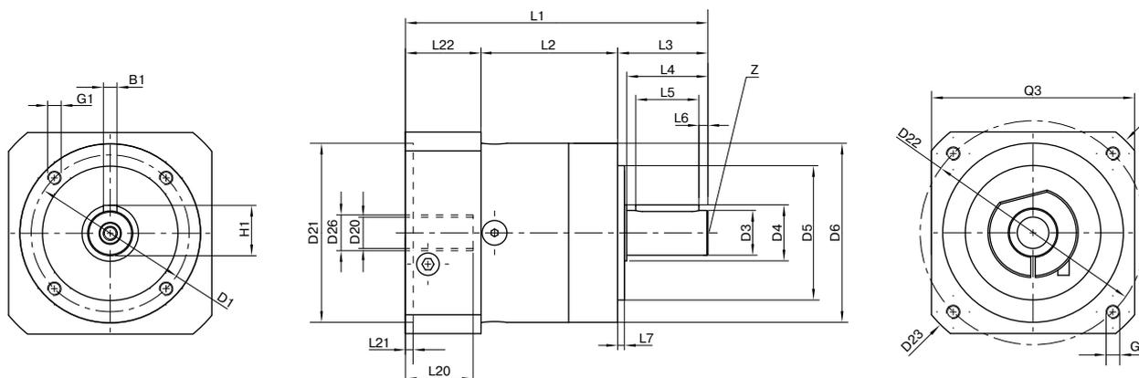
Darstellung entspricht einem PLE060 / 1-stufig / Abtriebswelle mit Passfeder / 11 mm Spannsystem / Motoranpassung – einteilig / B5 Flanschttyp Motor
