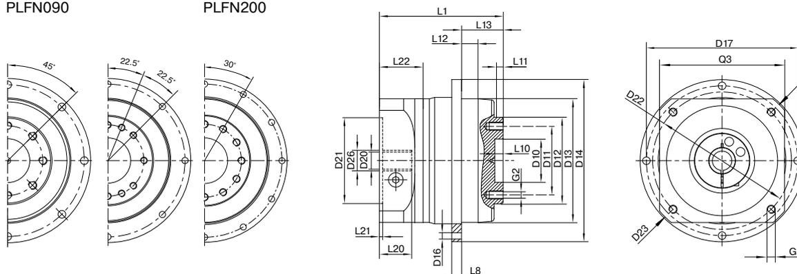
Darstellung entspricht einem PLFN090 / 1-stufig / Flansch-Abtriebswelle / 19 mm Spannsystem / Motoranpassung – 2-teilig – runder Universalfansch / B5 Flanschtyp Motor
