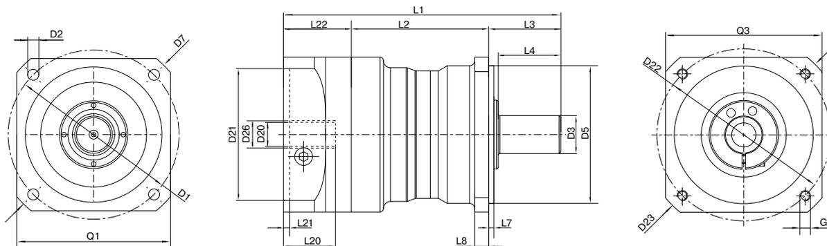
Darstellung entspricht einem PLN090 / 1-stufig / glatte Abtriebswelle / 19 mm Spannsystem / Motoranpassung – 2-teilig – runder Universalfansch / B5 Flanschttyp Motor
