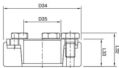
Für die Lastwelle wird eine Toleranz von h6 empfohlen, sowie eine Oberflächenrauigkeit  $Ra < 3,2 \mu m$
