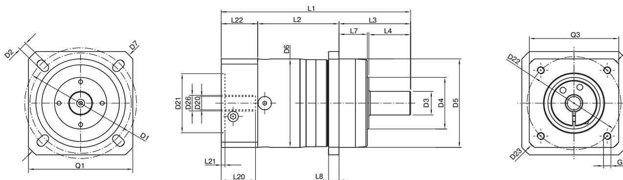
Darstellung entspricht einem PLHE060 / 1-stufig / glatte Abtriebswelle / 11 mm Spannsystem / Motoranpassung – einteilig / B5 Flanschttyp Motor
