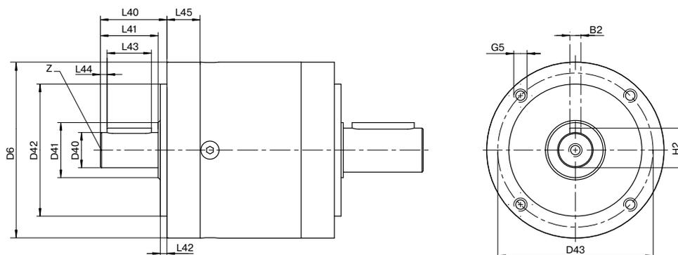
Darstellung entspricht einem PLE080 / 1-stufig / Abtriebswelle mit Passfeder / Antriebswelle - depiction corresponds to a PLE080 / 1-stage / output shaft with feather key / input shaft
