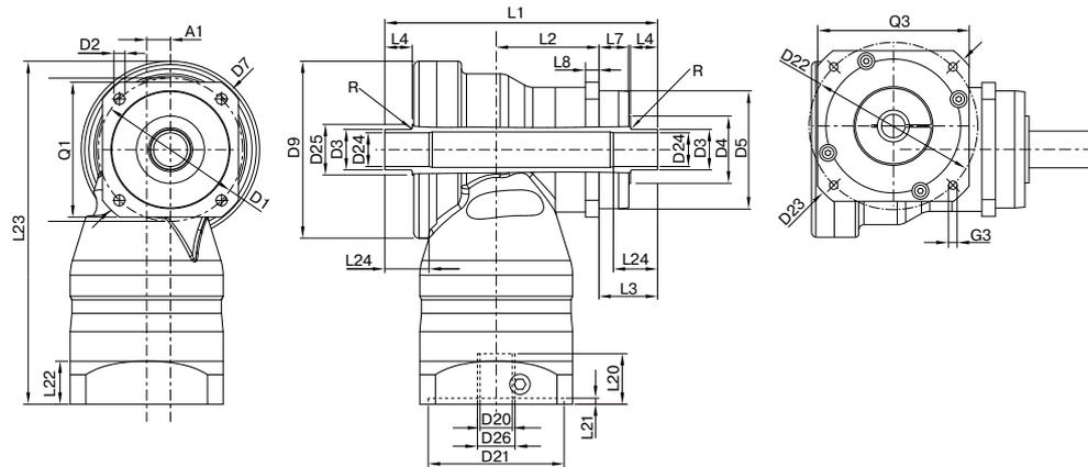
Darstellung entspricht einem WGN090 / 1-stufig / zweiseitige Hohlwelle am Abtrieb / 19 mm Spannsystem / Motoranpassung – 2-teilig – runder Universalfansch / B5 Flanschtyp Motor
