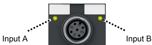
Abb. 52: Status-LEDs an M12-Buchsen
