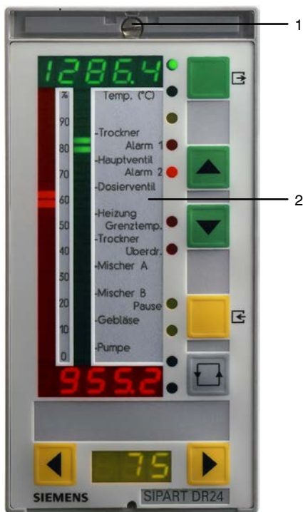
Bild 5-1 Frontbaugruppe mit herausgenommenem Messstellenschild und Messstellenschildklappe
