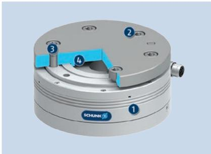
Das elektrische Drehmodul ERS ist für Applikationen mit hohen Ansprüchen an Plan- und Rundlauf geeignet. Zur Adaption und der richtigen Abnahme des Rundlaufs steht in der Basisvariante und der Variante mit Drehdurchführung jeweils ein Zentrierdurchmesser zur Verfügung. Dieser ist in der Hauptansicht sichtbar. Die Verdrehsicherung des Aufbaus kann über einen Passstift sichergestellt werden.
