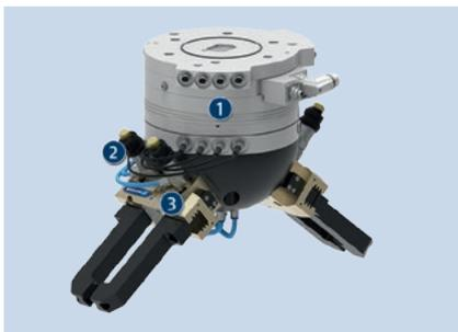
Die optionale Drehdurchführung des ERS bietet die Möglichkeit acht elektrische Signale und eine Druckluftversorgung durch das Modul zu führen. Der elektrische Anschluss erfolgt jeweils über acht 3-polige M8-Steckverbinder an Antriebs- und Abtriebsflansch. Die Druckluftversorgung kann am Abtrieb wahlweise über einen seitlichen Abgang oder einen schlauchlosen Direktanschluss abgenommen werden.
