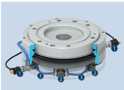
Die Haltebremse wird pneumatisch betätigt. Im nicht beaufschlagten Zustand ist die Haltebremse aktiviert. Die Ansteuerung der Bremse erfolgt über zwei Mikroventile, die wiederum über den jeweiligen Antriebsregler angesteuert werden können. Die Mikroventile sind im Lieferumfang enthalten.
