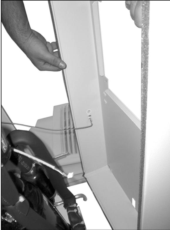
Abb. 72: Erdungskabel abziehen (1)
