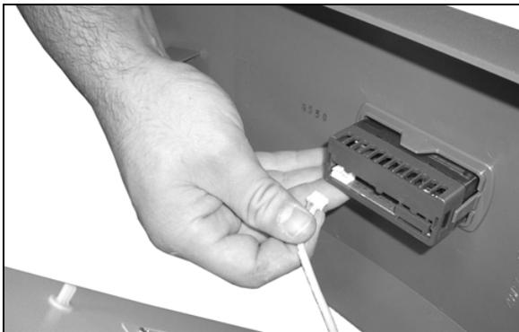
Abb. 60: Displaykabel abziehen
