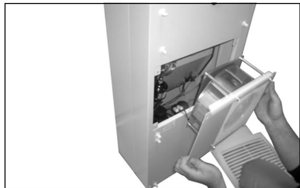
Abb. 64: Außenkreislaufventilator ausbauen
