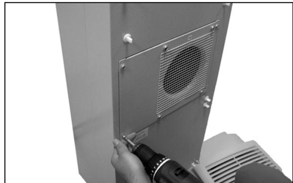
Abb. 63: Vier Schrauben des Außenkreislaufventilators lösen
