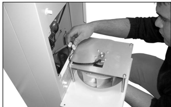
Abb. 65: Steckverbindungen des Lüfters abziehen (1)
