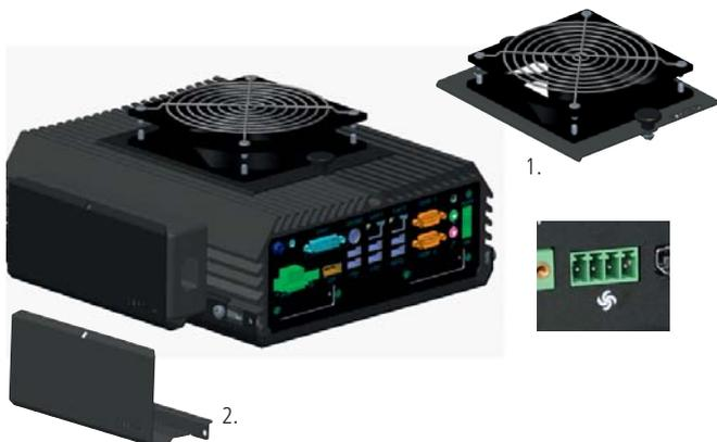
1. Externer Lüfter anschließbar um bei extremen Außentemperaturen eine ausreichende Kühlung zu gewährleisten.
