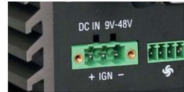
Power Ignition-Funktion, zeitgesteuertes Herunterfahren, ideal für KFZ-Anwendungen
