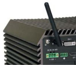
Integriertes mPCIe-Modul für Wireless Communication (Wi-Fi / 3G / GPS)
