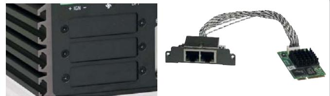
Universal Bracket für Mini-PCIe Karten wie z.B. serielle, USB, GLAN, Kamera-Module, DIO, Feldbusmodule, Real Time Ethernet...
