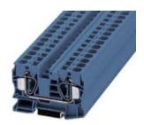
Durchgangsklemme, Anschlussart: Zugfederanschluss, Querschnitt: 0,2 mm² - 25 mm², AWG: 24 - 4, Breite: 12,2 mm, Farbe: blau, Montageart: NS 35/7,5, NS 35/15
