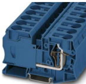
Durchgangsklemme, Anschlussart: Zugfederanschluss, Querschnitt: 2,5 mm<sup>2</sup> - 35 mm<sup>2</sup>, AWG: 14 - 2, Breite: 16 mm, Farbe: blau, Montageart: NS 35/7,5, NS 35/15
