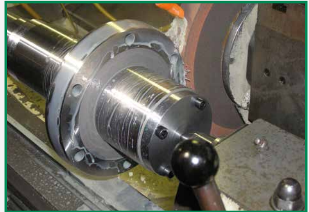
Außenrundscheifen des Kegels 1:4 einer Motorspindelwelle Outside round grinding of the taper 1:4 of a motor spindle shaft
