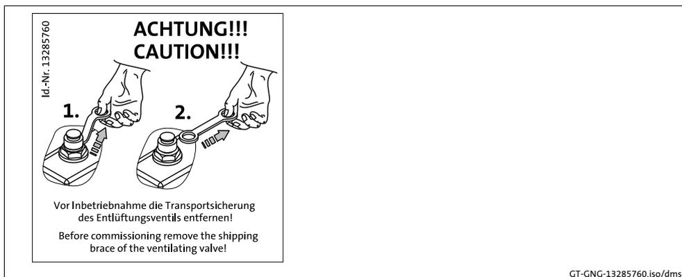
Bei Abweichung von den Standardeinbaulagen A - F muss die Funktion der Entlüftung geprüft werden. Lose beigefügte Entlüftungen (abweichend vom Standard) nach Kap. 5.3.11 montieren. Getriebe, die für mehrere Einbaulagen (☞ 66) geeignet sind, werden ohne Entlüftung ausgeliefert.
