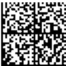
Fig. 13: Example DMC 1P 072222 SBTN k4p562d7 1K EL1809 Q 1 51S 678294
