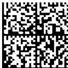
Abb. 13: Beispiel-DMC 1P 072222 SBTN k4p562d7 1K EL1809 Q 1 51S 678294
