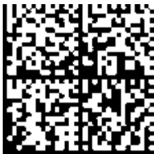
Fig. 20: Example DMC 1P 072222 SBTN k4p562d7 1K EL1809 Q 1 51S 678294
