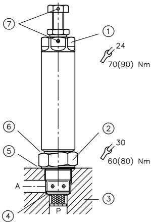
1. Kontermutter und Dichtmutter vor dem Einschrauben des Ventils bis zum Anschlag zurückdrehen.
