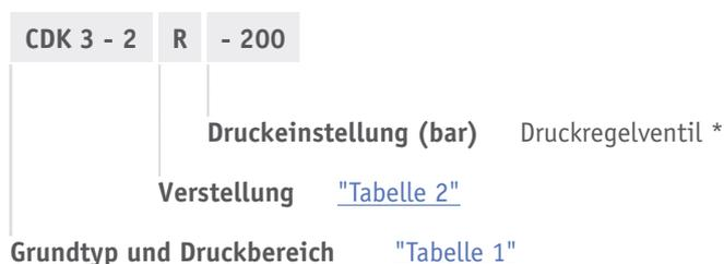
\* Ist kein Druckeinstellwert angegeben, wird das Ventil werkseitig auf den Maximalwert des jeweiligen Druckbereiches eingestellt.
