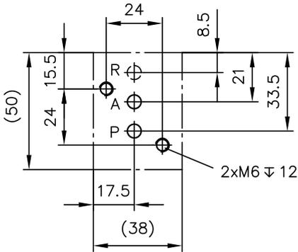
Das Bohrbild entspricht dem von Typ ADM 11 P nach [D 7120](#). Die O-Ring-Ansenkung für den Leckölanschluss R (bzw. L) ist vorhanden, wird aber nur beim Typ CDK...-SP benötigt.
