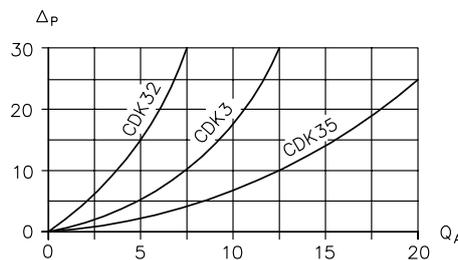
$Q_A$  Volumenstrom (l/min);  $\Delta p$  Durchflusswiderstand (bar)
