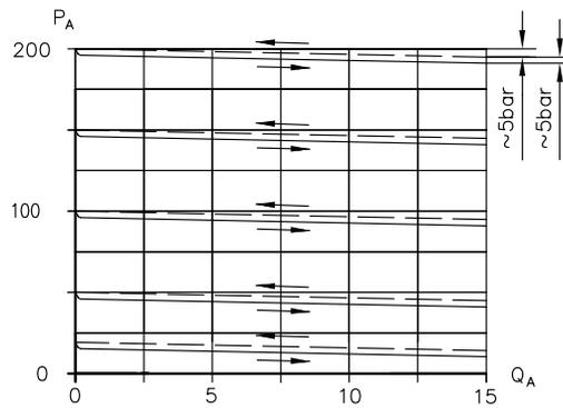
$Q_A$  Volumenstrom (l/min);  $p_A$  Ausgangsdruck (bar)
