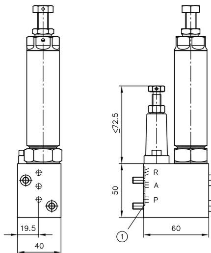
1 Abdichtung durch O-Ringe 7,65x1,78 NBR 90 Sh
