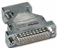
DICNET®-Adapter zum Anschluß von Nockensteuerungen mit RS485-DICNET®-Schnittstelle an eine COM-Schnittstelle am PC
