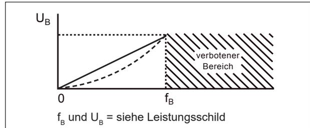
Bei Nichtbeachtung steigt der Motorstrom überproportional an und der Antriebsmotor kommt nicht auf Bemessungsdrehzahl.
