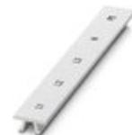
Zackband, Streifen, weiß, beschriftet, längs bedruckt: L1, L2, L3, N, PE, Montageart: verrasten in hoher Schildchennut, für Klemmenbreite: 16,3 mm, Schriftfeldgröße: 10,5 x 16,25 mm, Anzahl der Einzelschilder: 5
