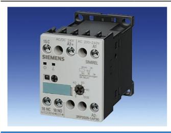
SOLID-STATE TIME-DELAY RELAY ON-DELAY 1 CHANGEOVER CONTACT AC/DC 24V, AC 200 TO 240V 0.05 S TO 100H WIDTH 45MM SCREW TERMINALS
